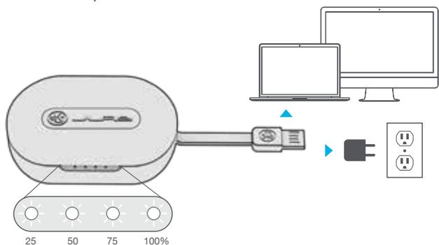
I LED mostreranno una luce bianca lampeggiante la carica; una volta terminata la carica, le spie diventeranno fisse.
