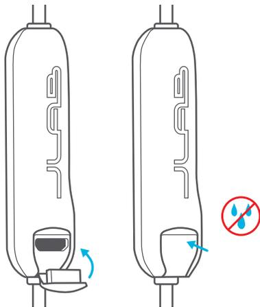
Antes de carregar, o Fit Sport 3 necessita de estar completamente seco. Se houver alguma exposição a humidade, os componentes internos podem ser danificados. Antes de carregar, o melhor é deixar secar ao ar livre.
